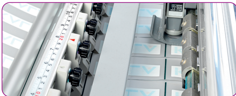
トリマーでカットするためのY型ブレードのセット
