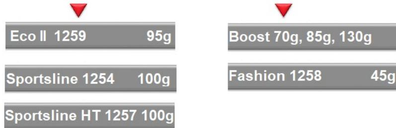
Sappi 社の場合、前述の **Swellable Coating** 方式で製造されているのが、上記の左側の製品群です。また、**Micro Porous Coating** 方式で製造されている速乾性の製品群は上記の右側の製品群です。
